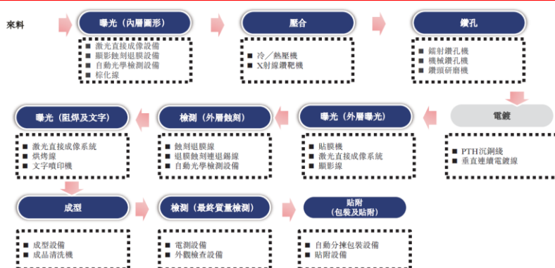
图 9：PCB 主要生产工序及所需设备
