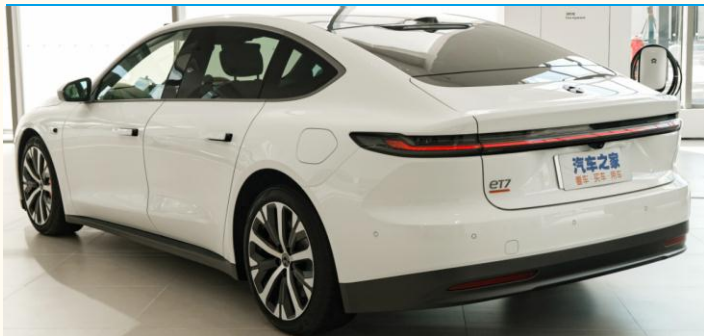
图表 8：蔚来 ET7 采用双边弹开电动门把手
