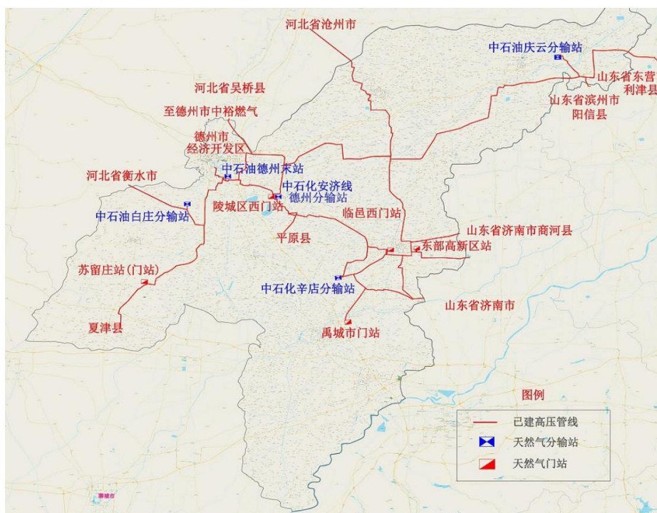
图表2: 山东中邑天然气高压管网图
