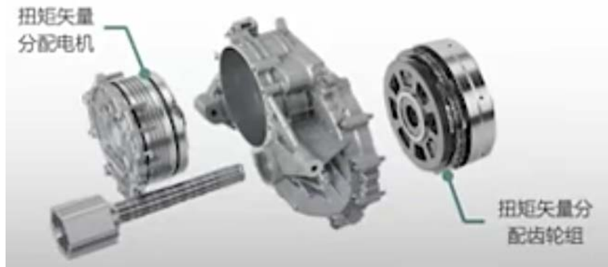
图：eTV电桥结构拆解
