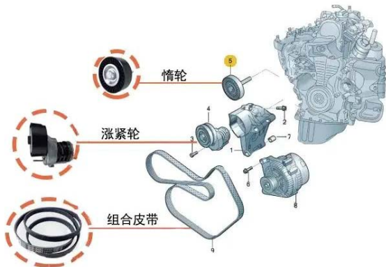
图：张紧器结构拆解
