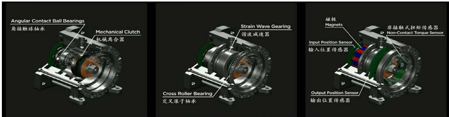
图：特斯拉Optimus旋转执行器结构拆解
