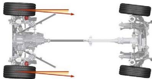
图：智能后轮转向系统工作原理图
