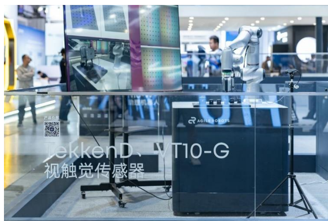
图表 5：采用视触觉传感器的电动二指夹爪（Tekken D）
