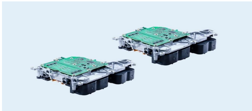
图：DENSO SiC 逆变器外观
