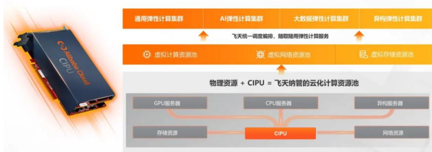
图 1：CIPU 向下对数据中心计算、存储、网络等底层基础设施快速云化并进行硬件加速，向上接入飞天云操作系统
