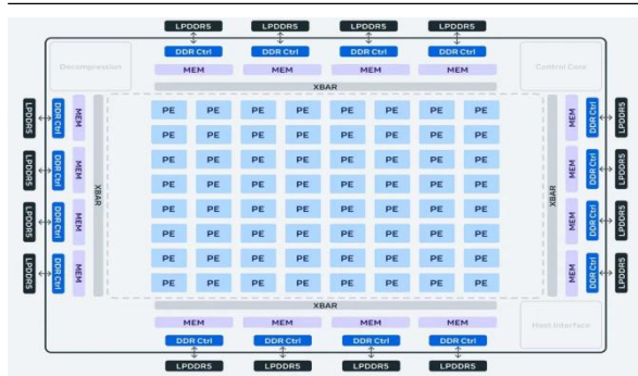
图18: Meta MTIA v2 芯片架构
