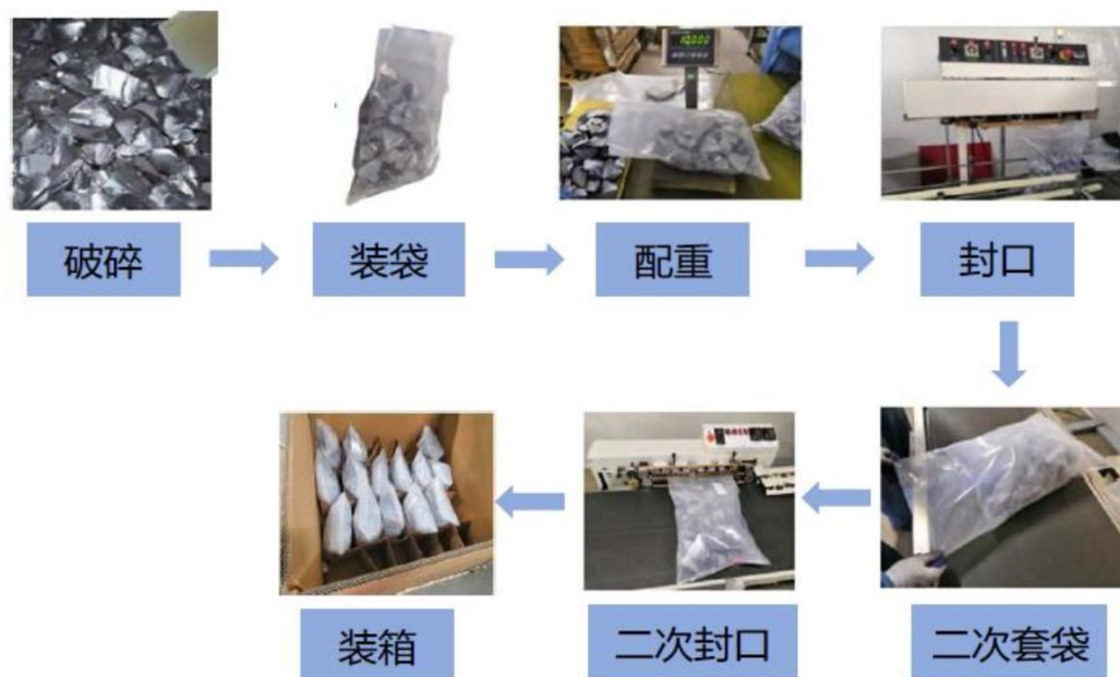
图 14：多晶硅破碎——装箱流程展示
