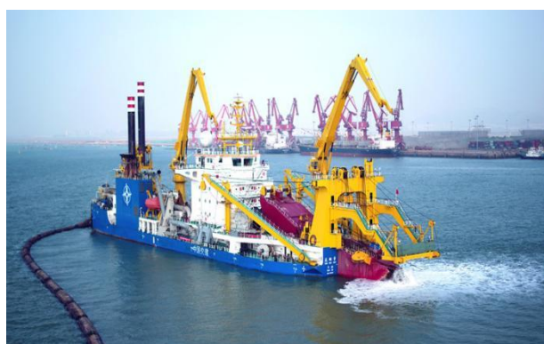
图17: 公司旗下亚洲最大的重型自航绞吸船“天鲲号”
