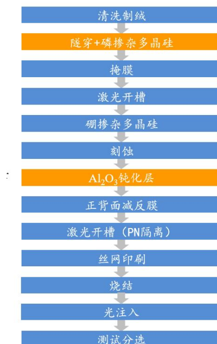
图 24：TBC 电池工艺流程
