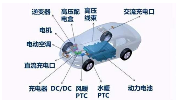
图 46：电动汽车高压系统
