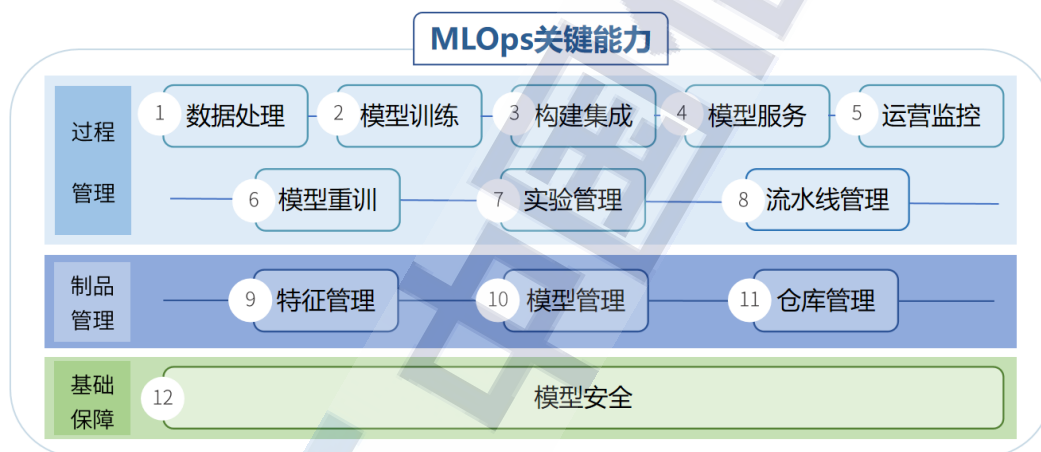
图 10 MLOps 关键能力示意图
