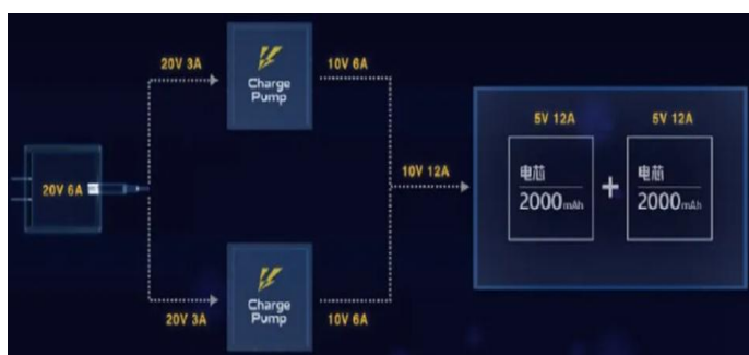
图 28：有线电荷泵技术快充示意图（iQOO 120W FlashCharge）
