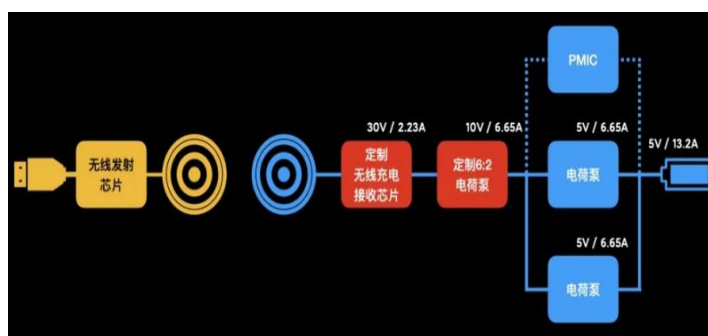
图 29：无线电荷泵技术快充示意图（小米 11Pro，兼容 80W 无线）
