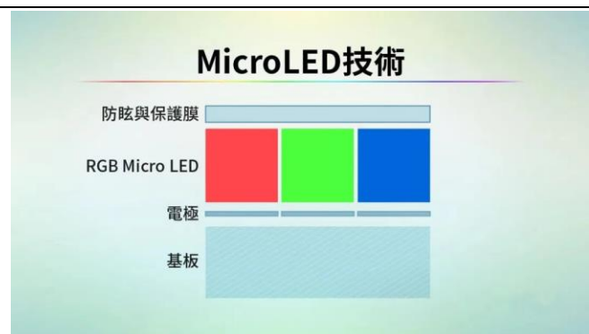
图表 52: Micro LED 结构
