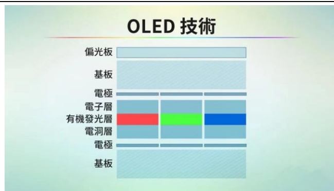
图表 51: OLED 结构
