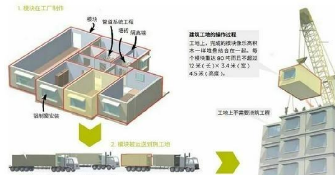
图 31：装配式建造示意图
