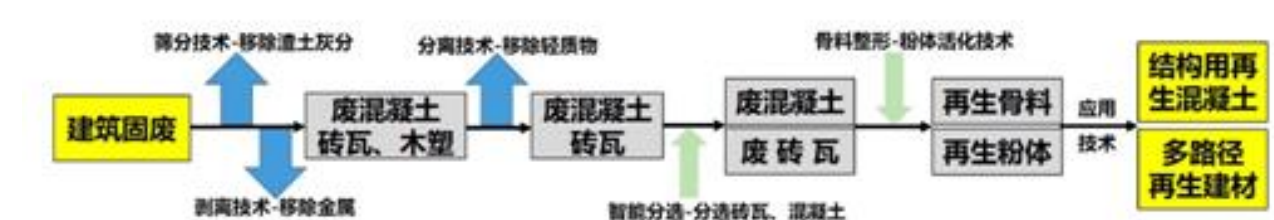
图 46：建筑固废资源化处置工艺流程
