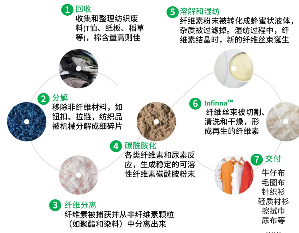
图 18：Infinited Fiber Company 的循环再利用流程
