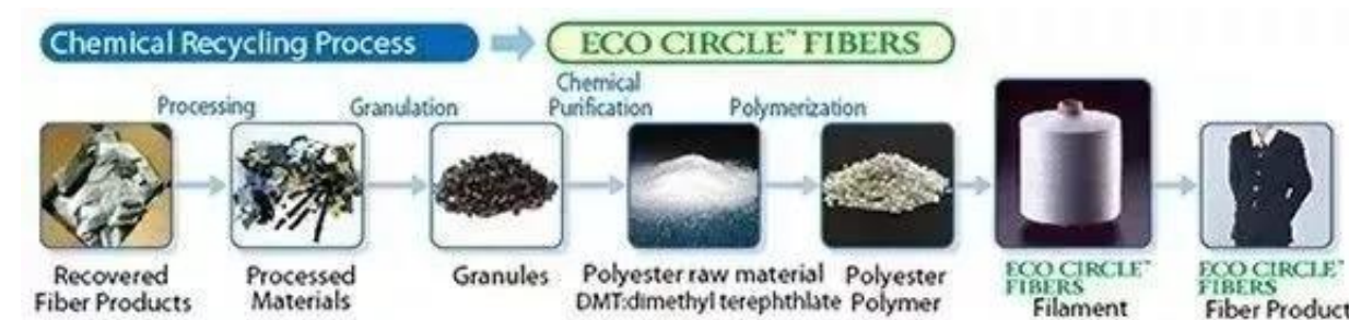
图 17：化学法循环利用的流程
