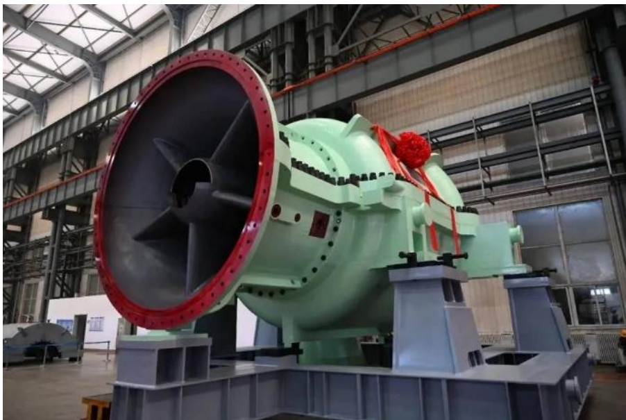
图 12：青海格尔木液态空气储能示范项目的压缩模块
