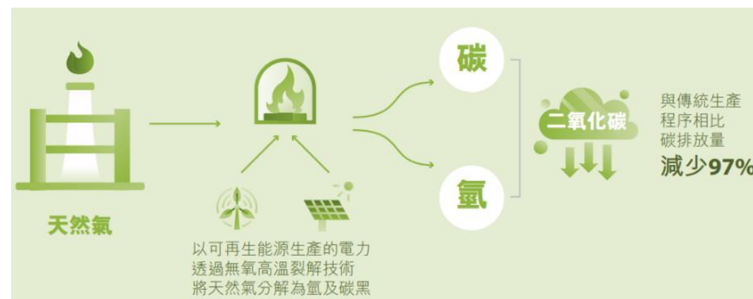
图 7.4 洁净氢及炭黑生产流程
