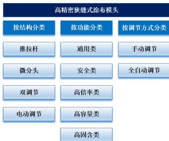
图5：高精密狭缝式涂布模头分类
