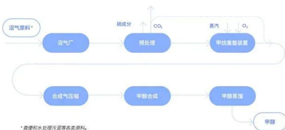
图2：生物甲烷制甲醇工艺流程图
