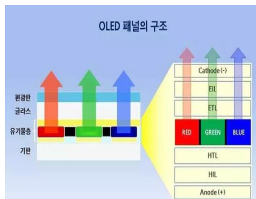
图59：OLED 发光原理示意图
