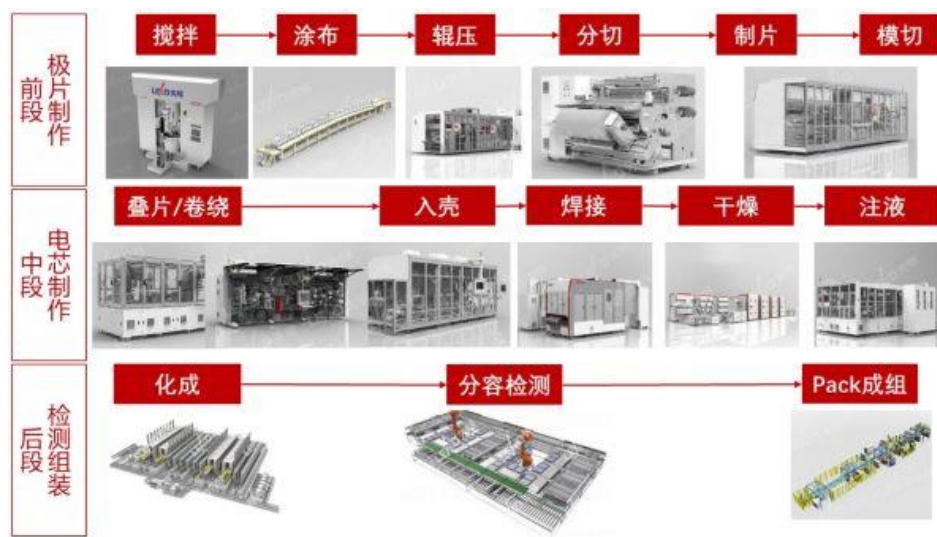
图61：锂电池工艺流程图
