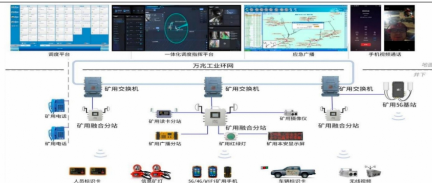
图 15：煤矿井下一体化通信系统
