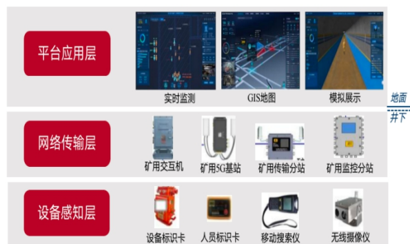
图18：智能矿山监控系统多层级软硬件构成
