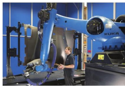
发动机短舱红外无损检测平台
