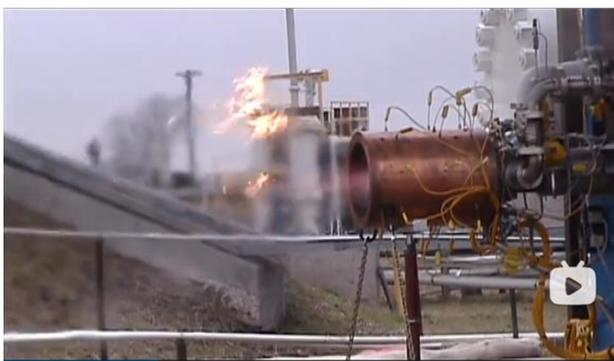
图3：Merlin 1A 发动机铜质燃烧室试车试验
