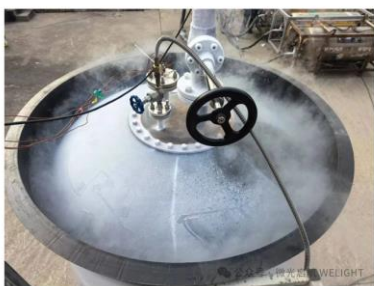
碳纤维复合材料贮箱低温测试
