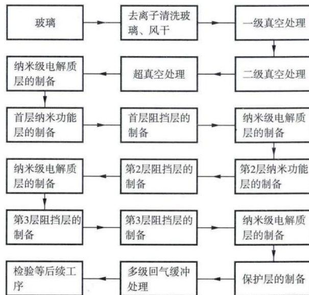
图26: 三银 low-E 玻璃生产工艺流程
