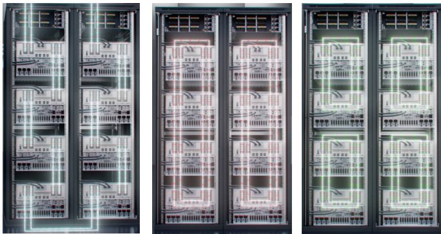
图 14 分布式光交换全光互连模组支持不同拓扑间的灵活切换
