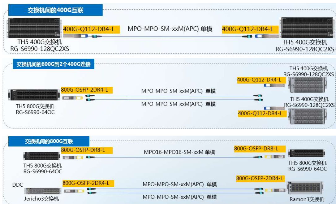
图 10 锐捷 LPO 模块在三种网络架构下的互连应用
