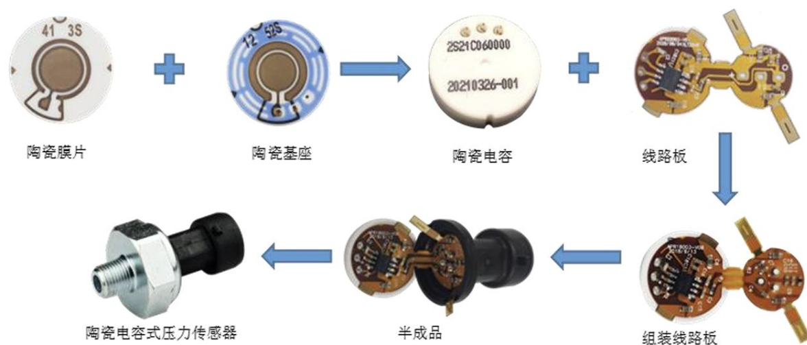
陶瓷电容式压力传感器工艺路线图
