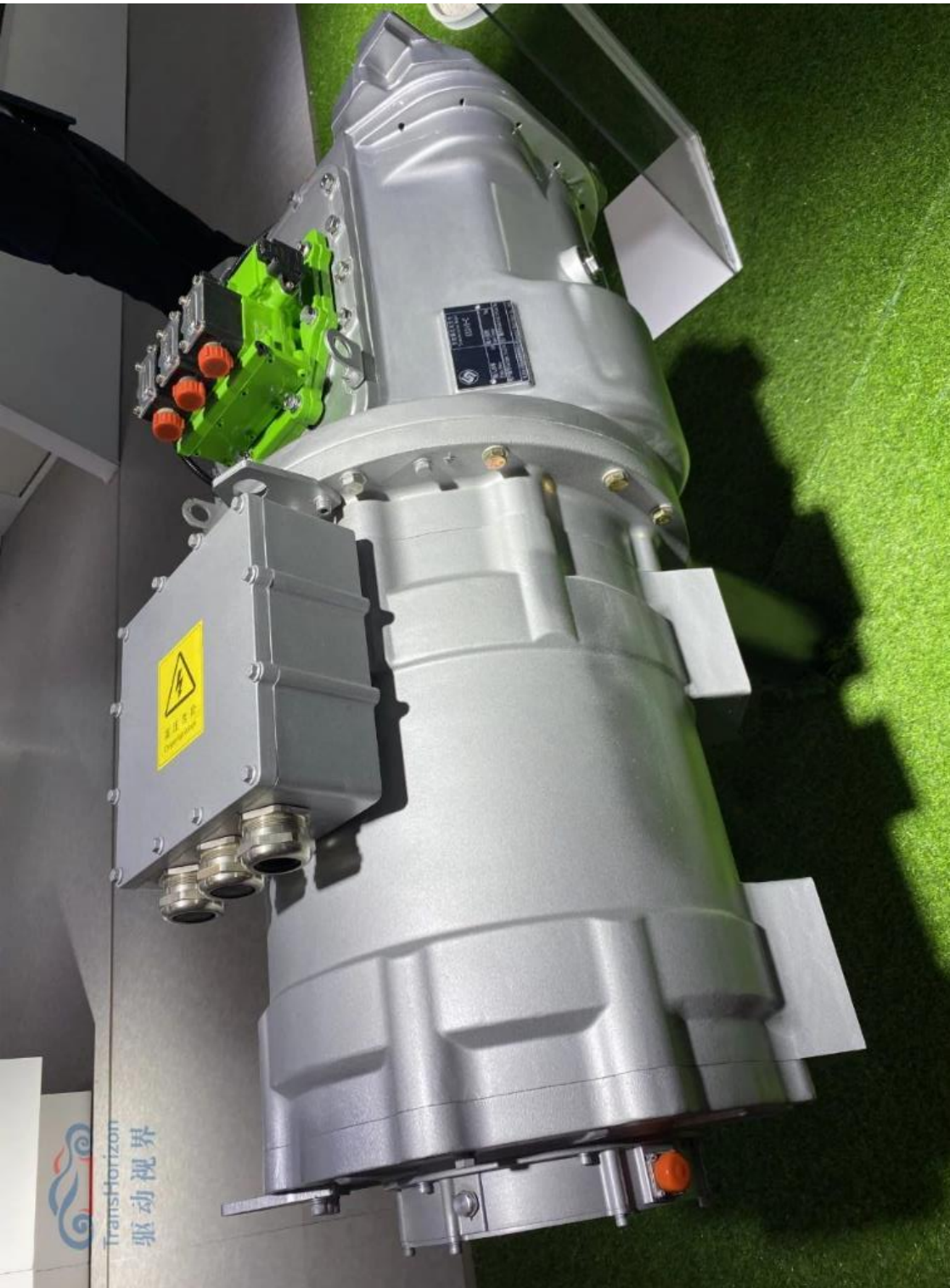
法士特6E240，一档速比8.48，可用于重型纯电卡车，系统最大输出扭矩达到2万Nm
