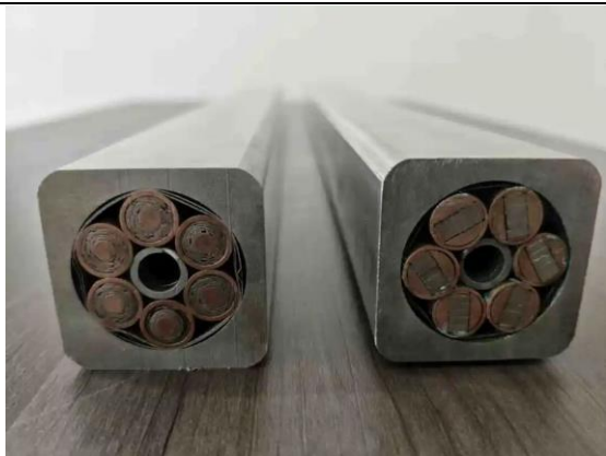
图3: CORC 子缆（左）和 TSTC 子缆（右）
