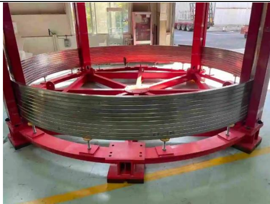
图4: 南网成功研制百米级大电流高温超导导体
