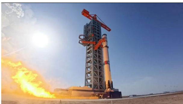
图1：朱雀三号于本周顺利完成加注合练及静态点火试验
