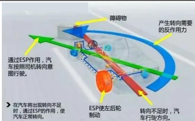
图表 19 ESC 系统工作原理
