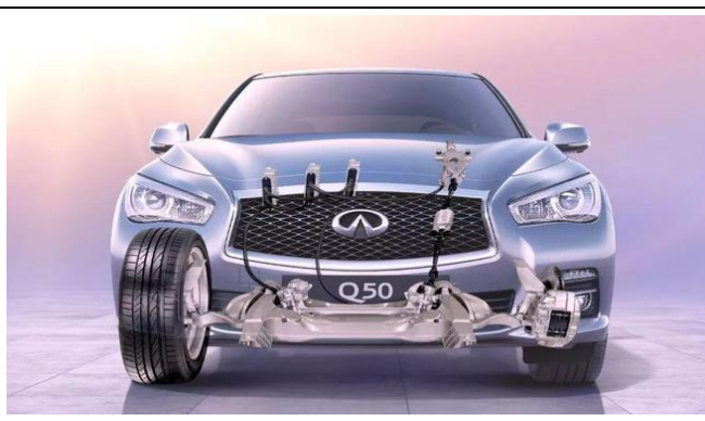
图表 57 英菲尼迪 Q50 线控转向
