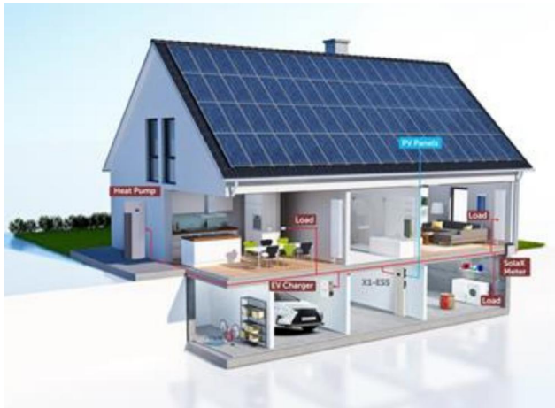
图 21：户用光伏储能系统可实现电能自发自用
