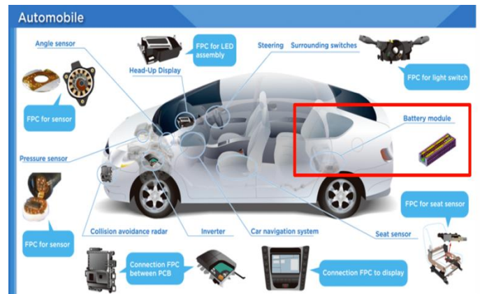
图表 18: 汽车 FPC 使用量约 100 片, 其中电车电池 BMS FPC 用量达 70 条以上
