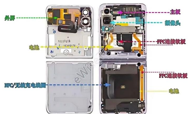
图表 16: 折叠屏手机被分成左右/上下两部分, 主板、电池和模组通常分布在两侧, 必须通过 FPC 跨越铰链做连接
