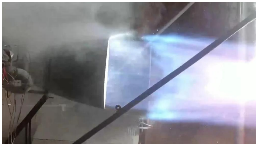
图表14：“蓝焱”220 吨级液氧甲烷全流量补燃循环发动机完成整机全系统长程试车
