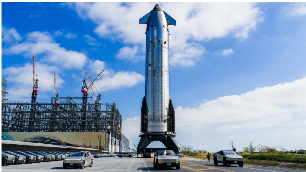
图表6: S39 计划从生产基地前往马西前哨站进行发射前低温耐压测试
