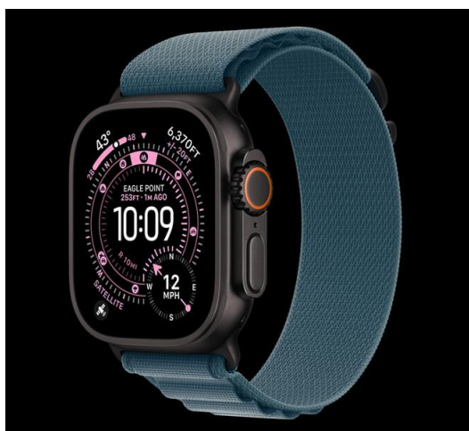
图表7：Apple Watch Ultra 3 钛金属表壳等注重外观质感，以激光抛光、化学机械抛光为主
