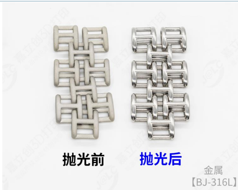
图表6：金属打印零件打磨抛光前后对比
