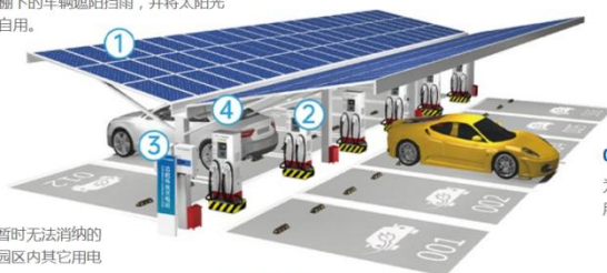
图92：芯能科技“光伏+储能+充电”智慧电动汽车充电站示意图
