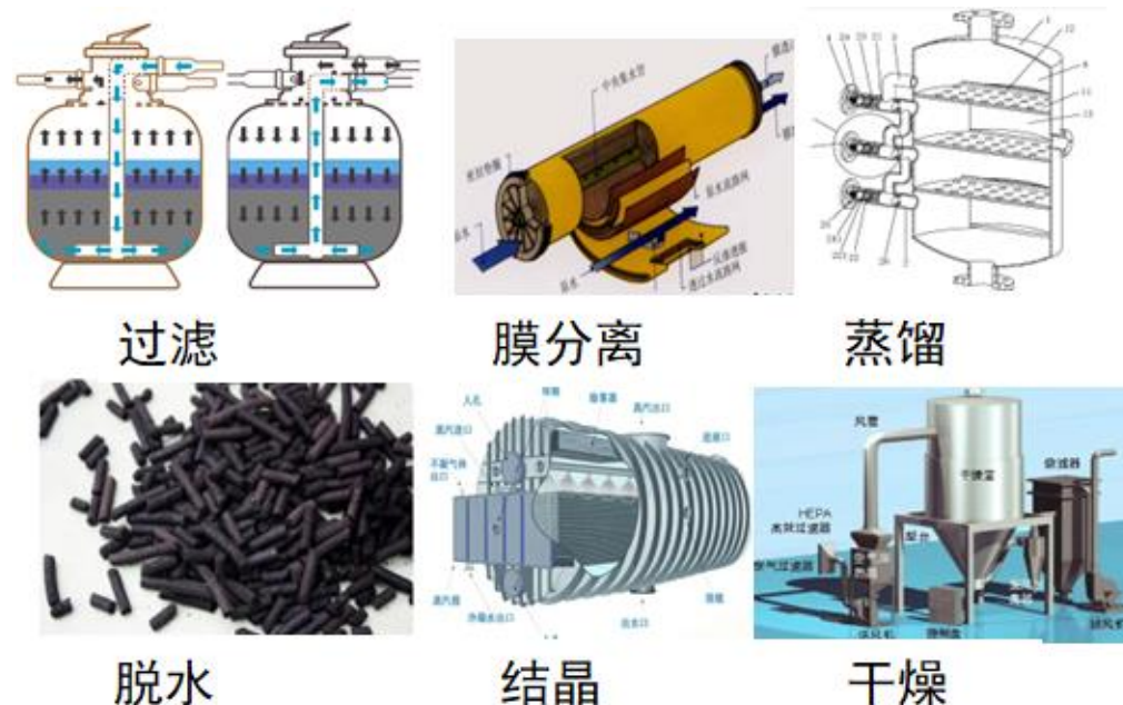
图：合成生物学产物分离纯化主要工艺
