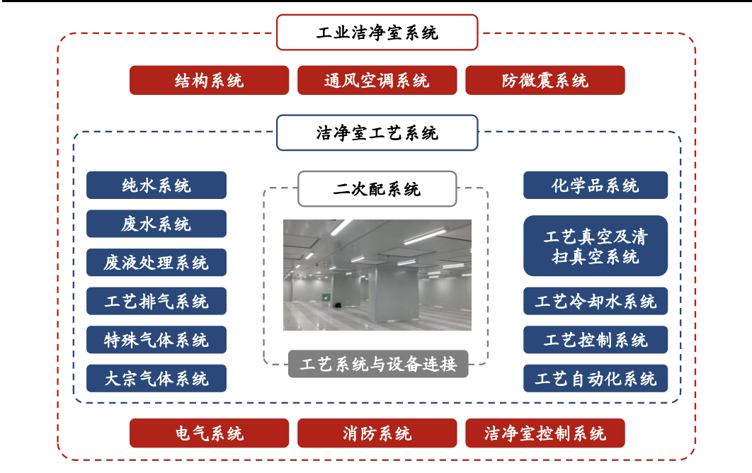
图2：工业洁净室系统构成
