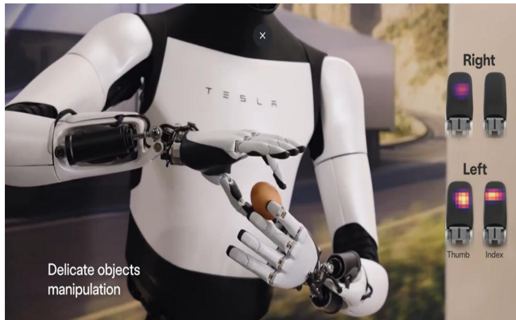
图：Optimus Gen2捏取鸡蛋涉及触力感知
