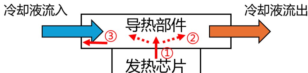
图表1：三个传热环节影响芯片散热效果
