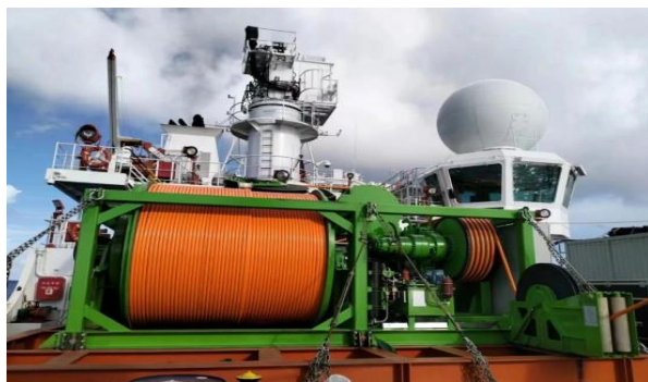
图 24：中国船舶深海采矿重载布放回收绞车
