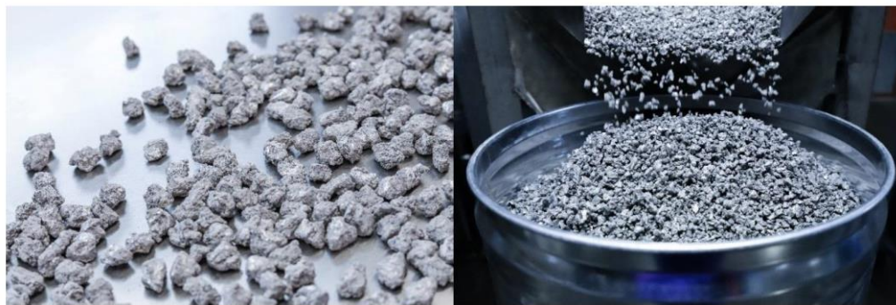
图4：海绵钛是钛金属单质，一般为浅灰色颗粒或海绵状
